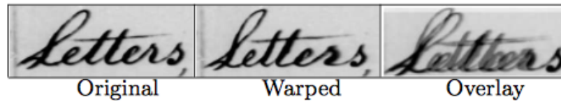
Abbildung 3.2.4: Das erste Bild zeigt das ursprüngliche Wortabbild. In der Mitte ist das künstlich erzeugte Wortabbild. Das letzte Bild zeigt den Unterschied der beiden Wortabbilder, indem diese überlappt werden. Bild entnommen aus [HRM05].
