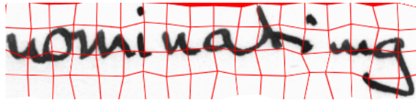
Abbildung 3.6.3: Visualisierung der Random Grid Warp Augmentation von [WSD + 17]. Das Bild wird verzerrt, indem ein Gitter über das Bild gelegt wird und die Kontrollpunkte zufällig normalverteilt verschoben werden.
