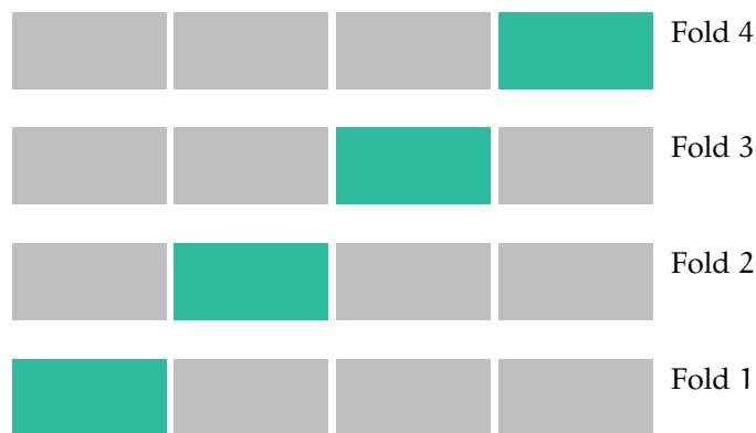
Abbildung 5.2.2: Bei der Kreuzvalidierung wird ein Datenbestand in k gleichgroße Folds aufgeteilt. Im Rahmen der Validierung dient jeder Fold einmal als Testdatensatz während auf den restlichen Daten trainiert wird. Abgebildet ist die Aufteilung von Trainingsdaten (grau) und Testdaten (grün) in den jeweiligen Folds für k = 4 .
