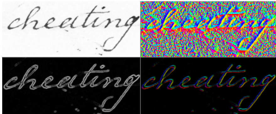
Abbildung 2.2.2: Gradientenbild mit Sobel-Operator. Oben links: Graustufenbild. Unten links: Bild der Magnituden, Darstellung im Grauwertbereich. Je heller desto größer die Magnitude. Oben rechts: Bild der Orientierungen im Bogenmaß. Darstellung im HSV-Farbraum (siehe auch [Pri15] Kapitel 3.2.4). Jede Farbe steht für eine Orientierung, ähnliche Farben entsprechen ähnlichen Orientierungen. Unten rechts: Kombination der Magnituden und Orientierungen. Darstellung im HSV-Farbraum.
