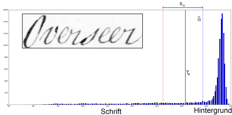
Abbildung 2.1.1: Beispiel für den Niblack-Schwellwert für ein Wortabbild des Wortes "overseen".
