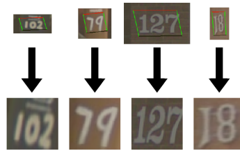
Abbildung 5.3.1: Die obere Reihe stellt die Eingabe des Netzwerks N (SPP-Prim) dar und die untere die Ausgabe der ersten STN Schicht, welche hier mit Spatial Pyramid Pooling kombiniert ist.
