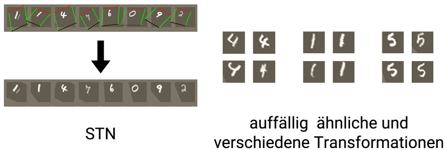
Abbildung 5.2.1: Einfluss eines STN innerhalb der N_2 Architektur. Das STN bestimmt Gitter über der Eingabe (Durch die Mehrfarbige Box gekennzeichnet), womit die Ausgabe dieser Schicht berechnet wird. Auffällig ist, dass gleiche Zahlen oft ähnlich transformiert werden, obwohl dessen Eingabe mit zufälligen Transformationen versehen ist. Die 5 wird oft leicht nach links gedreht dargestellt und die 1 sowie 4 oft leicht nach rechts. Dies könnte einen Einfluss auf die Genauigkeit des Klassifikators haben.
